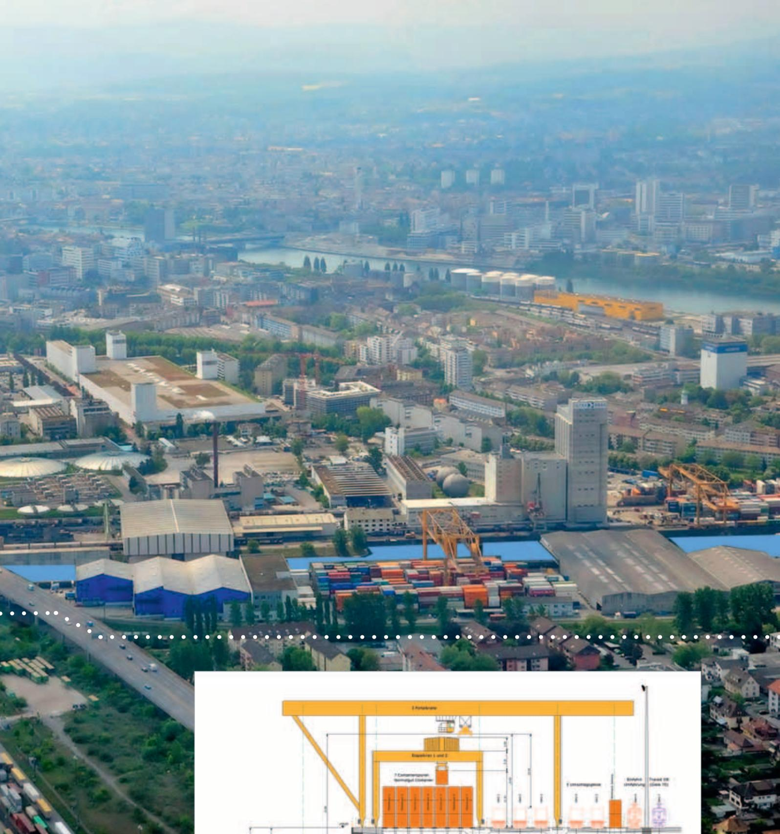
Querschnitt mit Hafenbecken 3, zweistufigem Kranconzept, Lagerflächen für Container sowie Gleisanlagen.
