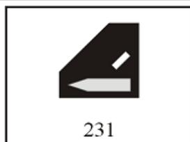
Auf der Rückseite der Zwergsignale weist ein aufgemalter weisser Pfeil auf das zugehörige Gleis. Zeigt das Zwergsignal *Fahrt* oder *Fahrt mit Vorsicht*, ist dies an einem weissen schrägen Lichtstreifen (Rücklicht) erkennbar.
